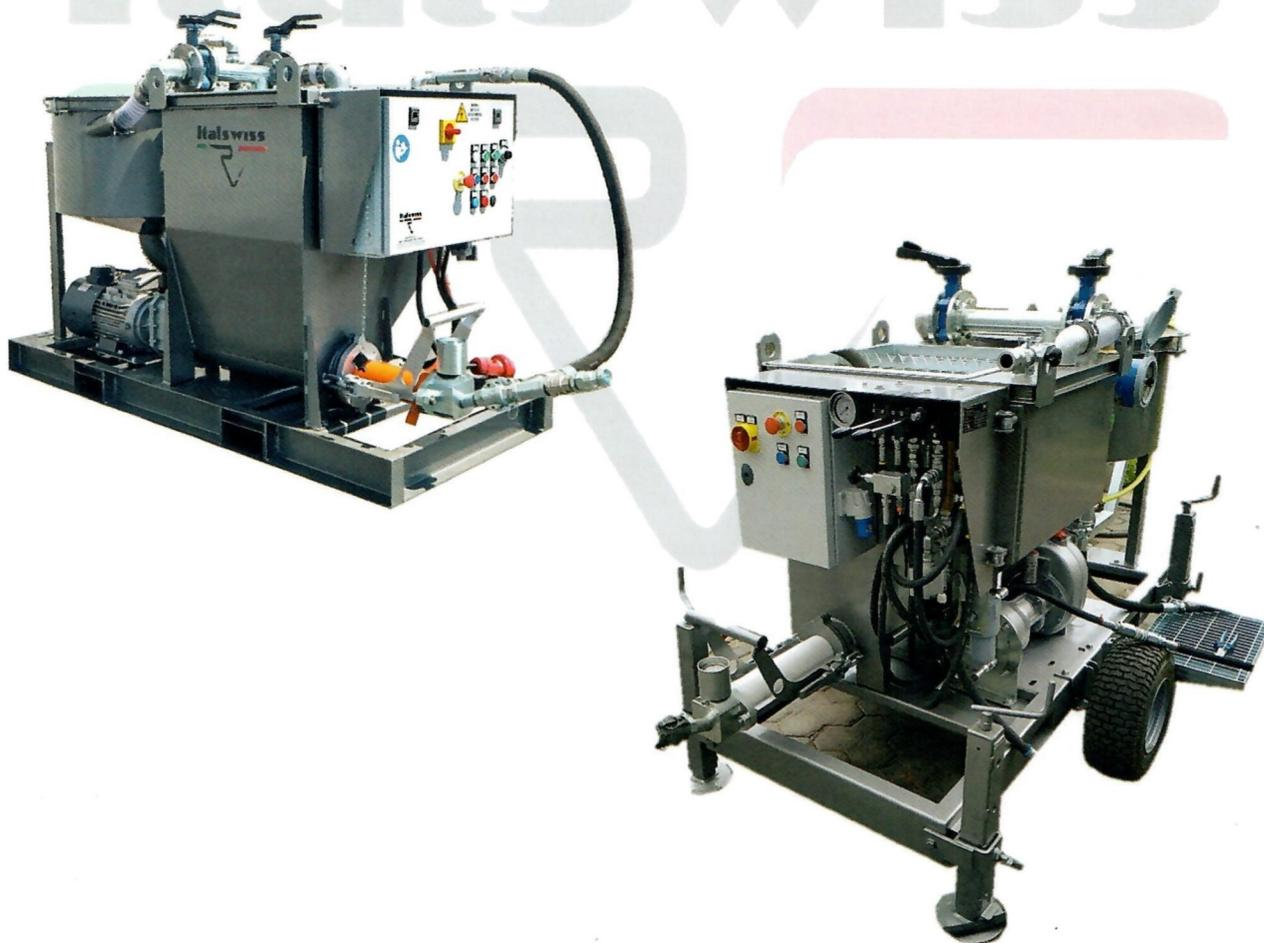
Le système de mélange et d'injection VARANO peut être réalisé en version électrique ou hydraulique. Dans la version électrique de Varano, la pompe à vis est alimentée par un moteur à aimants permanents qui permet une faible absorption électrique et la possibilité de tourner à des vitesses très basses, ce qui permet de régler la vitesse d'injection comme on le souhaite.
