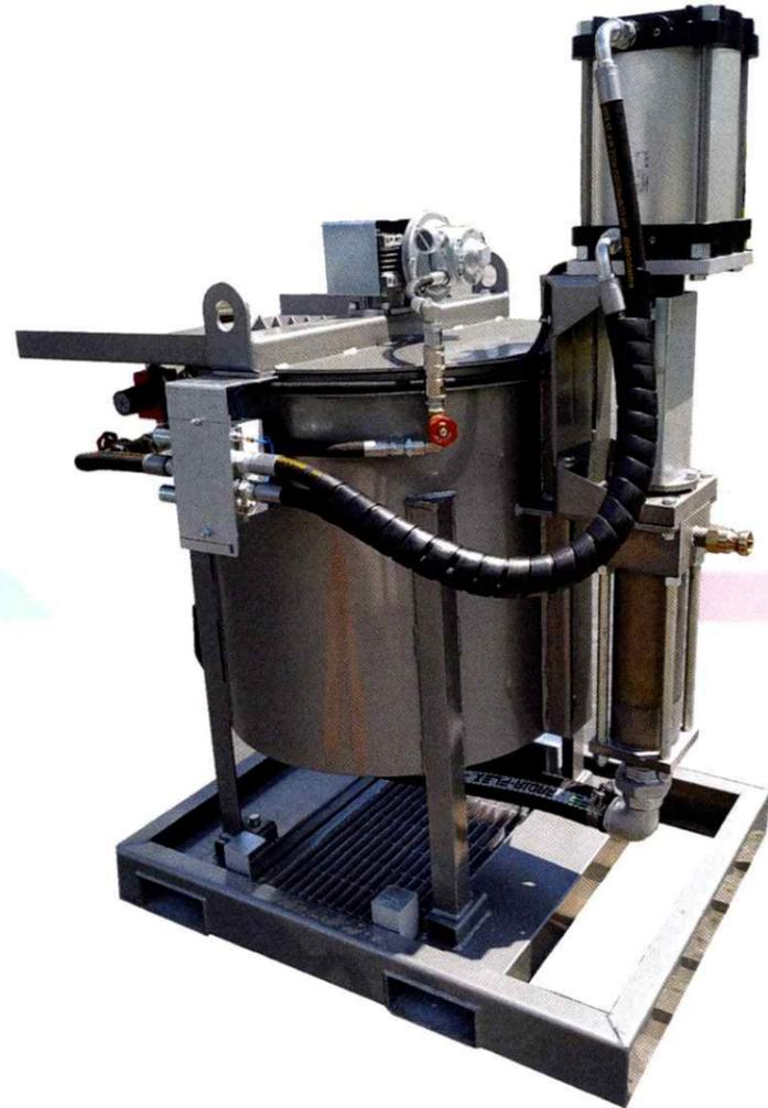
Le système de mélange et d'injection Mini Air Grout II est conçu pour offrir un débit élevé avec un système aux dimensions compactes. Le puissant actionneur pneumatique garantit un débit de 75 l/min et des pressions allant jusqu'à 60 bar, pour couvrir une variété de travaux tels que :
