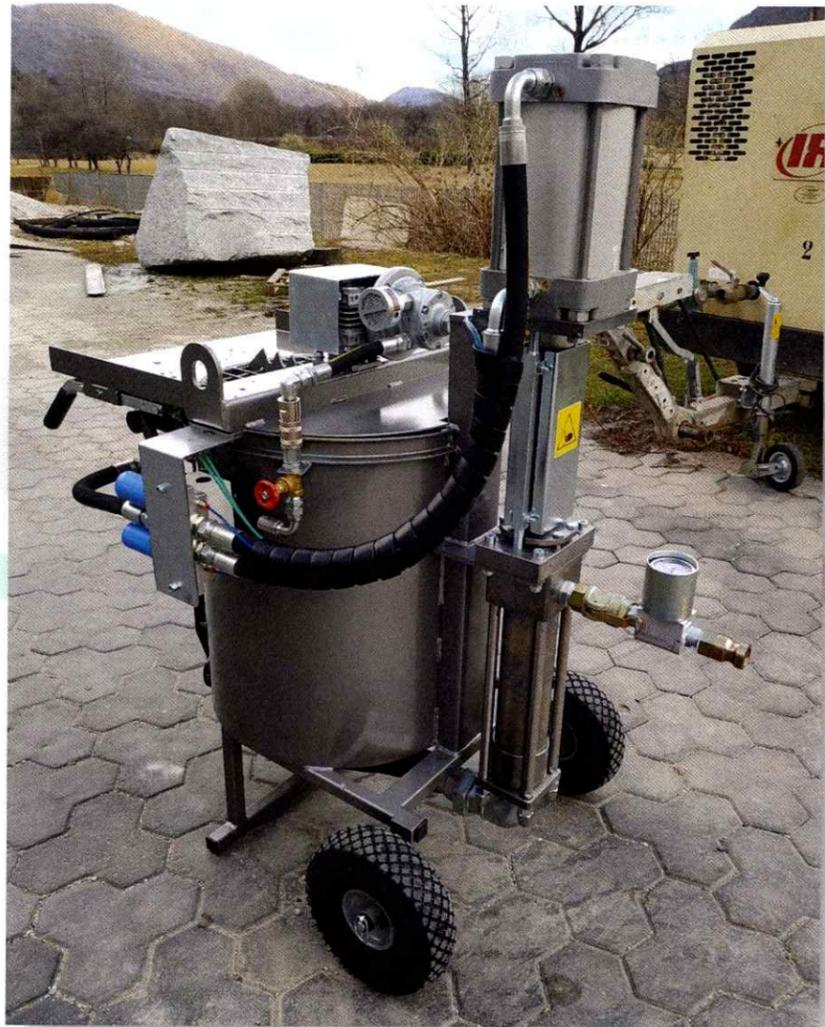
Le système de mélange et d'injection portable Mini Air Grout I est conçu pour faciliter l'utilisation et le transport au sein d'un chantier. Le puissant injecteur pneumatique permet d'obtenir des pressions allant jusqu'à 85 bar et des débits allant jusqu'à 60 l/min, couvrant ainsi les principaux besoins des chantiers tels que :
